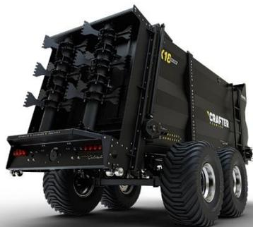
Складные распределители с лопастными элементами продолжают работу при контакте с посторонними веществами с помощью системы BYPASS
